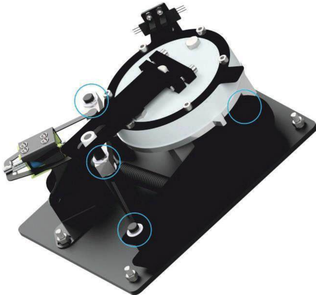
Рисунок 12.5.1 - Места смазки подвижных частей
