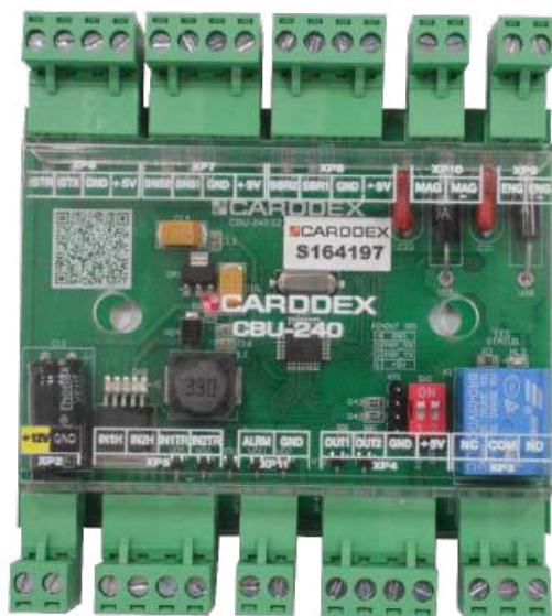
Рисунок 6.3.1 Контроллер управления турникетом «CBU-240» Dip-переключатели
