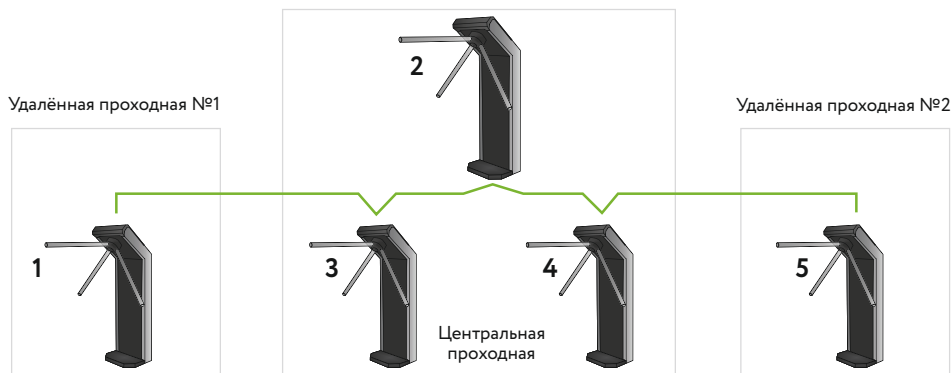
Рисунок 9.9 - Пример размещения оборудования
