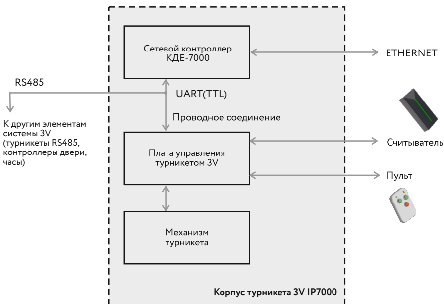
Рисунок 2.5 – Структура турникета IP7000
